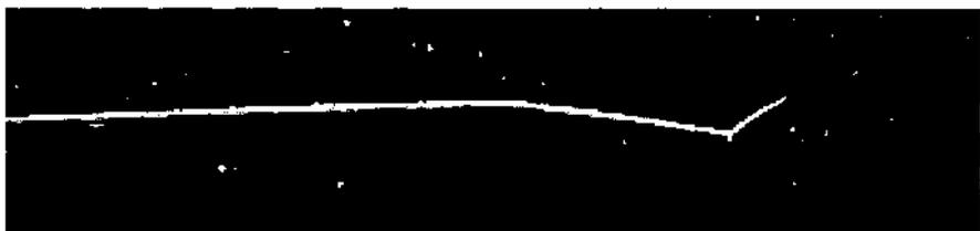
Рис. 1 След в камере Вильсона, возникший в результате радиоактивного распада атома. Считается, что след возникает в результате пролета альфа-частицы, испущенной атомом радона, расположенным на картинке слева. (С. Т. R. Wilson, Proc. Roy. Soc., London (A) 87, 277 (1912))
